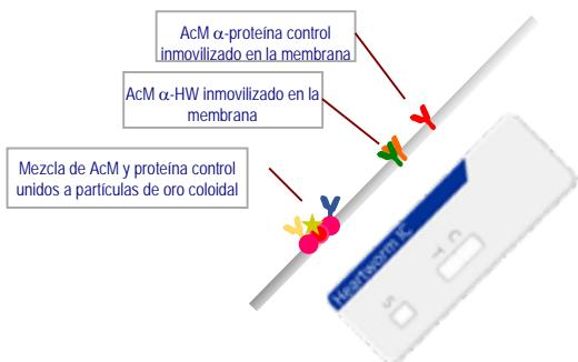
El dispositivo de diagnóstico está compuesto por una placa de plástico con 2 ventanas:
